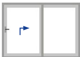
A 2-kwaterowe z jednym skrzydłem ruchomym
