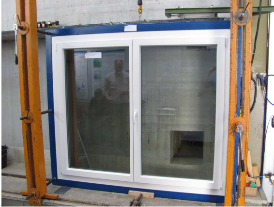
Bild 1 Probekörperansicht auf Prüfstand Fenster geschlossen
