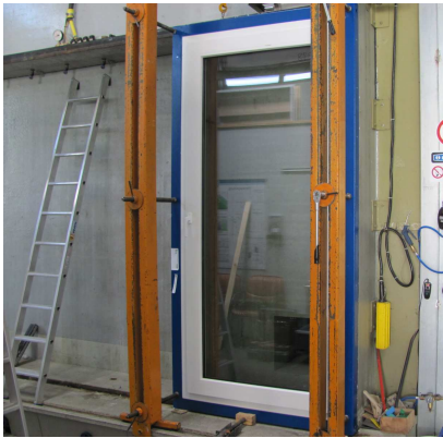
Bild 1 Probekörperansicht auf Prüfstand Fenster geschlossen
