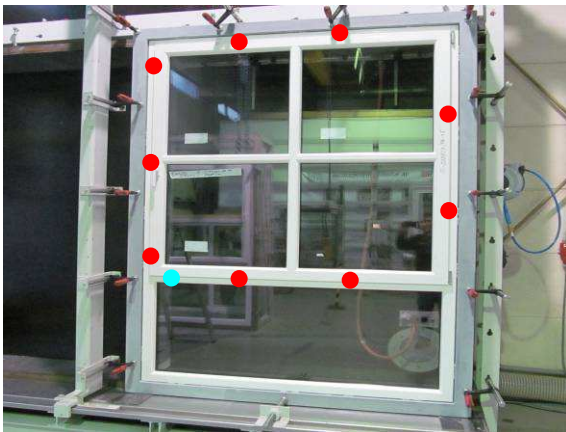
Bild 8 Positionsplan der Verriegelungen
