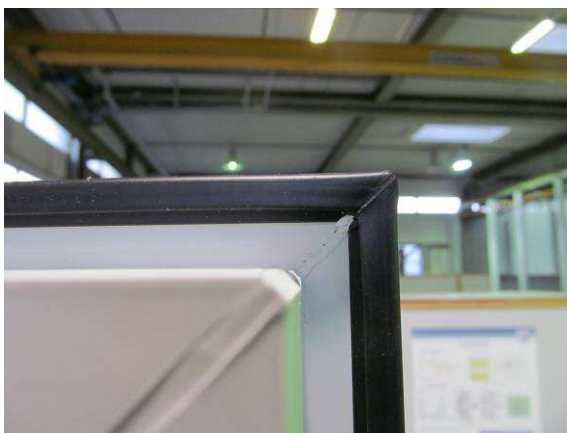
Bild 2 Innere Anschlagdichtung Eckausbildung
