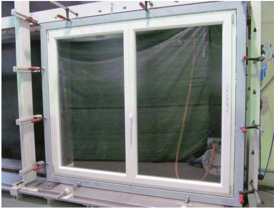
Bild 1 Probekörperansicht auf Prüfstand Fenster geschlossen
