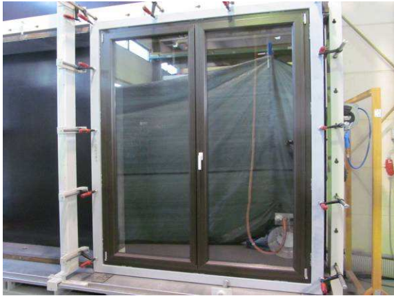
Bild 1 Probekörperansicht auf Prüfstand Fenster geschlossen
