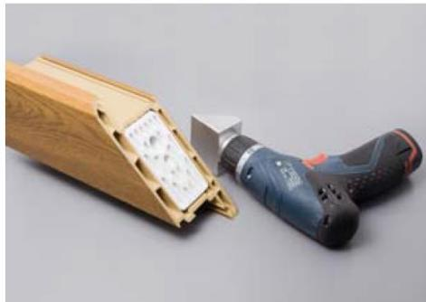
6. Flügel fertig zum Verschweißen
