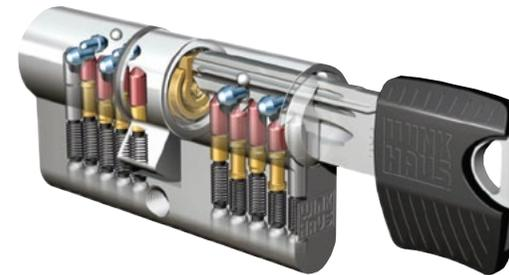
Vielseitig und sicher - heute und in Zukunft. KeyTec RPE von Winkhaus ist das innovative System für die einzelgesicherte Schließung. Ein neuartiger Kopierschutz gibt Ihnen die Gewissheit, dass nur befugte Personen einen Nachschlüssel anfertigen können. Dies wird erreicht durch eine speziell ausgeprägte Rippe am Schlüssel, die im Schließzylinder durch eine Sperrkugel abgefragt wird.
